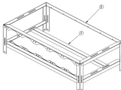
**5°** - Próximo passo unir a estrutura superior à estrutura inferior, através dos pés. Os pés superiores indicados pela letra A devem ser encaixados por fora da união das peças.
