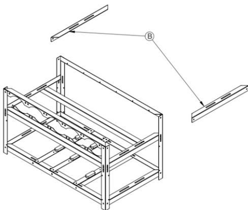
**2°**- Separar duas peças A e duas peças B (obs: uma das peças B é a que foi retirada da rig de 6 GPU's, mostrada no passo anterior). Fazer isso duas vezes conforme imagem abaixo.
